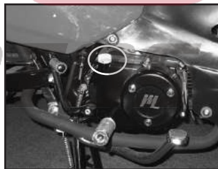
Tapa del orificio de llenado del aceite y bayoneta de nivel de aceite.
