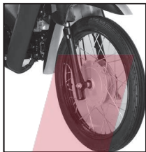
BLITZ (Base) Rueda delantera con freno a tambor de expansión interna.
