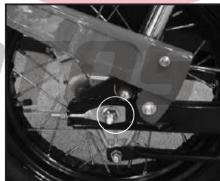
Tuerca de ajuste del freno trasero
