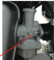
3. Cuando el motor no tenga velocidad de ralentí o funcione a una velocidad decreciente, el tornillo de regulación de velocidad debe estar entre las dos posiciones, para ayudar a la mezcla.
