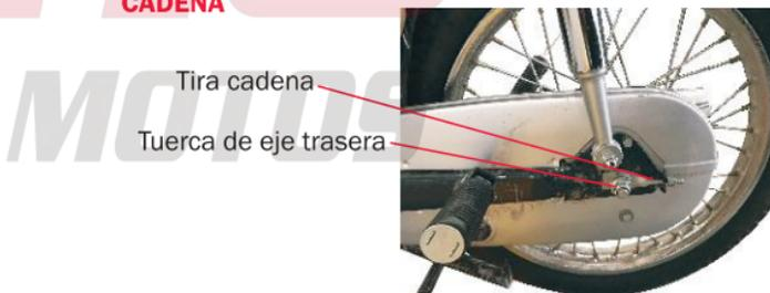
La vida útil de la cadena depende de una adecuada lubricación y ajuste. Un mantenimiento pobre puede causar desgaste prematuro o daño a la cadena. La cadena deberá ser chequeada y lubricada como parte de la inspección de pre-conducción. Bajo ese extremo, o cuando la moto es conducida en áreas polvorientas o con barro, una manutención más frecuente será requerida.
