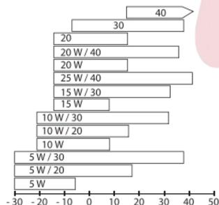
Este vehículo es provisto con aceite para motor SAE15W/40-SE class y este lubricante es adecuado sólo a temperaturas de 40°C a -10°C. Si es utilizado otro aceite este debe ser técnicamente equivalente en todo aspecto. La viscosidad varía según temperaturas y regiones, por lo tanto el lubricante debe ser seleccionado según nuestras recomendaciones.
