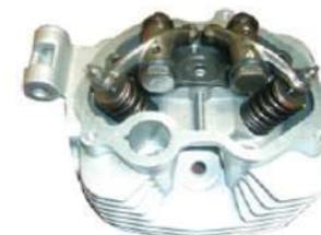
Girar el eje cigüeñal del motor en sentido antihorario hasta que la marca T quede alineada con la marca del orificio visor. De esta forma quedará en el punto inferior de compresión, donde ambas válvulas estarán cerradas, y así podrá ajustar su luz. Presione el balancín, si este se mueve fácilmente, la válvula está cerrada. Si la válvula no se mueve, gire el eje 360° y alinee las marcas nuevamente. Controle la luz insertando una galga entre la válvula y el tornillo de regulación.
