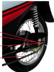
La vida útil de la cadena depende de una adecuada lubricación y ajuste. Un mantenimiento pobre puede causar desgaste prematuro o daño a la cadena. La cadena deberá ser chequeada y lubricada como parte de la inspección de pre-conducción. Bajo ese extremo, o cuando la moto es conducida en áreas polvorientas o con barro, una manutención más frecuente será requerida.
