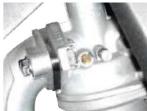
3. Cuando el motor no tenga velocidad de ralenti o funcione a una velocidad decreciente, establezca el tornillo de detenimiento de velocidad en el medio entre las dos posiciones límite, para ayudar a que se mezcle el combustible y el aire.
